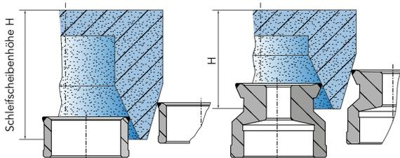
Die neue Formrollenvariante mit einem verringertem Durchmesser von  $\varnothing 50$  mm und einer Standardhöhe von 28 mm (links) ermöglicht die Verwendung höherer Schleifscheibentöpfe.
